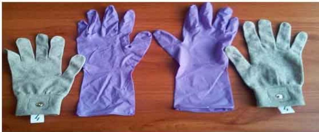
**Fig. 3.** Guantes conductores en ambos bordes y al centro guantes aislantes de látex o vinilo.
