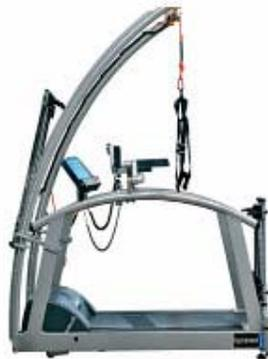
**Fig. 1.** Sistema RoboWalk Expander en estera de marcha h/p/cosmos med
